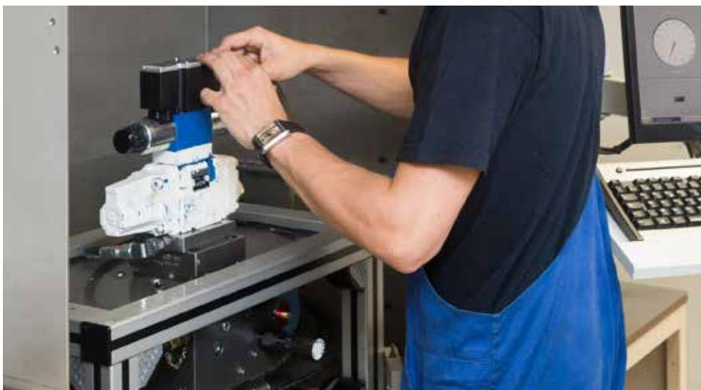
Une fois réparée, chaque vanne est testée sur notre banc de test informatisé selon les spécifications d'usine. REM-B HYDRAULICS fournit un certificat de test pour chaque vanne réparée. De cette façon, vous êtes assuré du parfait reconditionnement de votre vanne.
